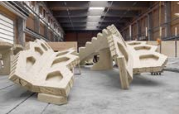
↑ To industrirobotter har fremstillet 376 forskellige pladesegmenter med 17.000 forskellige fingerskarringer.
