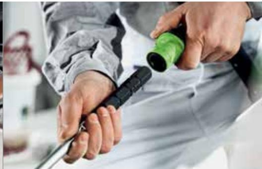
**Durchdacht und schnell:** Werkzeugloses Trennen von Rührkorb und Rührwerk.
