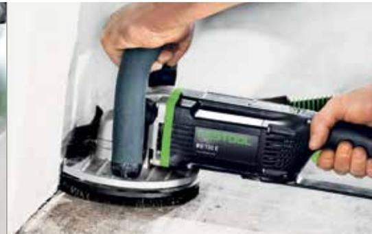
**Randnah arbeiten:** Mit dem Diamantschleifer RENOFIX RG 130 E kann durch das abklappbare Segment bis an die Wand geschliffen werden.
