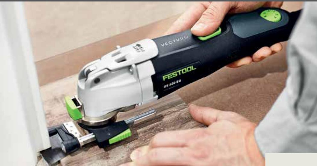
**Schnell und werkzeuglos montiert:** Der Tiefenanschlag beim Oszillierer VECTURO OS 400 für Eintauchschnitte mit definierter Tiefe.
