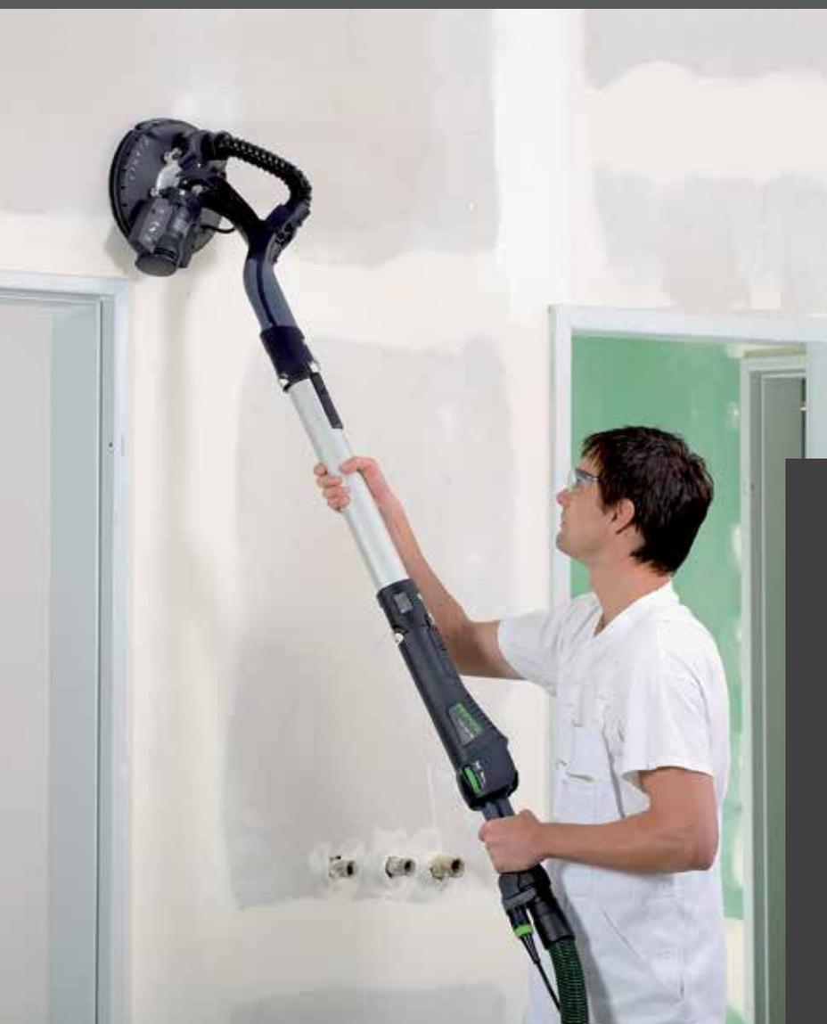
**Kurz, lang, stark an Wand und Decke:** Schneller, starker Abtrag mit bis zu 30 kg pro Stunde durch robustes, zweistufiges Getriebe und variabel verstellbare Arbeitslänge – Langhalsschleifer PLANEX LHS 225.
