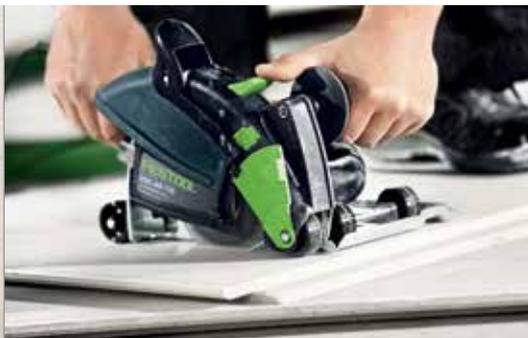
**Baustoffe staubarm trennen:** Mit dem Diamant Trennsystem DSC-AG 125 für sauberes und präzises Arbeiten bis 27 mm Schnitttiefe.
