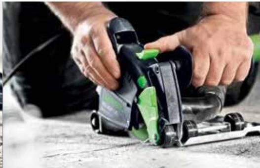
**Präzise und sauber:** Durch die Tauchfunktion der DSC AG 125 ist der Schnittbeginn an jeder Stelle im Boden möglich.
