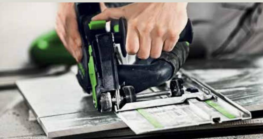
**Unschlagbar präzise:** Trennsystem DSC-AG plus Führungsschiene für den präzisen und staubarmen Zuschnitt von Fliesen und Naturstein.
