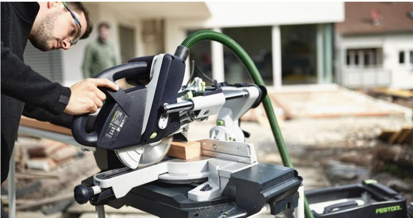
**Doppelte Präzision:** Extra stark dimensioniert und zweifach kugellagert. Die Festool Doppelsäulenführung garantiert die sichere und reibungslose Führung des Sägeblatts und steht für höchste Präzision.
