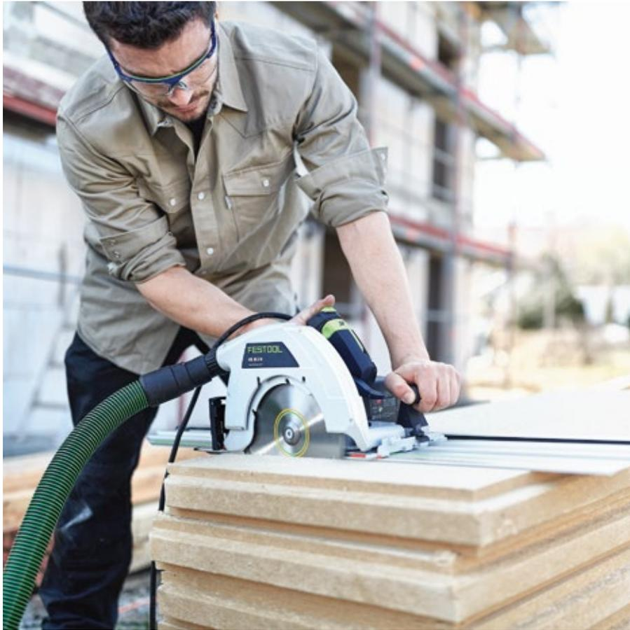
**Perfekt für bis zu 85 mm Materialstärke:** Mit der HK 85 gelangen perfekte Längs- und Querschnitte bis 85 mm Materialstärke. So gelingt der Zuschnitt von Dämmstoffen, Hölzern und Plattenwerkstoffen präzise und mühelos.
