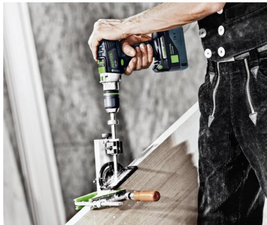
**Präziser bohren:** Mit dem Treppenbohrgerät GD D10-40 für die Bohrungen runder Stachetenverbindungen.
