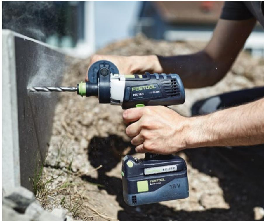
**Äußerst vielseitig:** Zum Bohren, Schrauben und Schlagbohren in Mauerwerk und Stein. Mit dem zuschaltbaren Axialschlag schafft der QUADRIVE PDC 18/4 exakte Löcher bis 10 mm Durchmesser.
