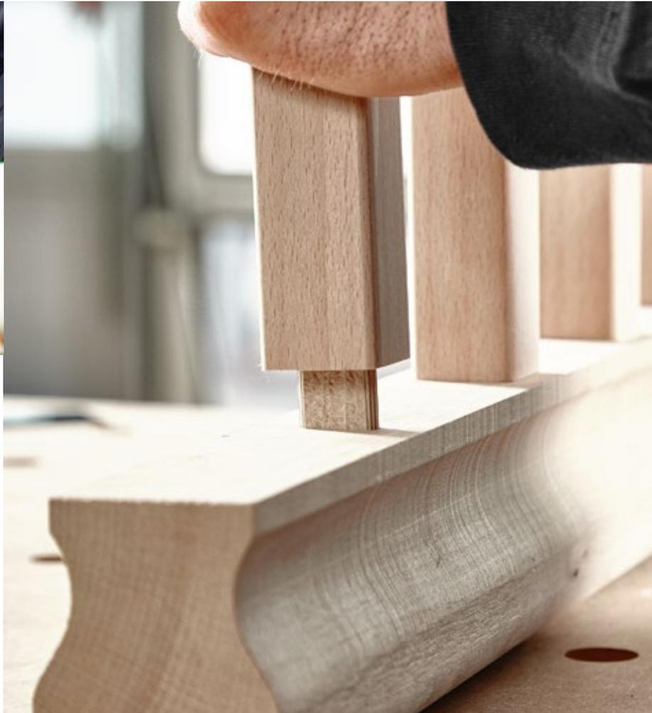
**Einmal einstellen, in Serie arbeiten:** Mit der Multi-frässchablone MFS und der Oberfräse OF 2200 sind Treppenschwangen schnell gefräst.
