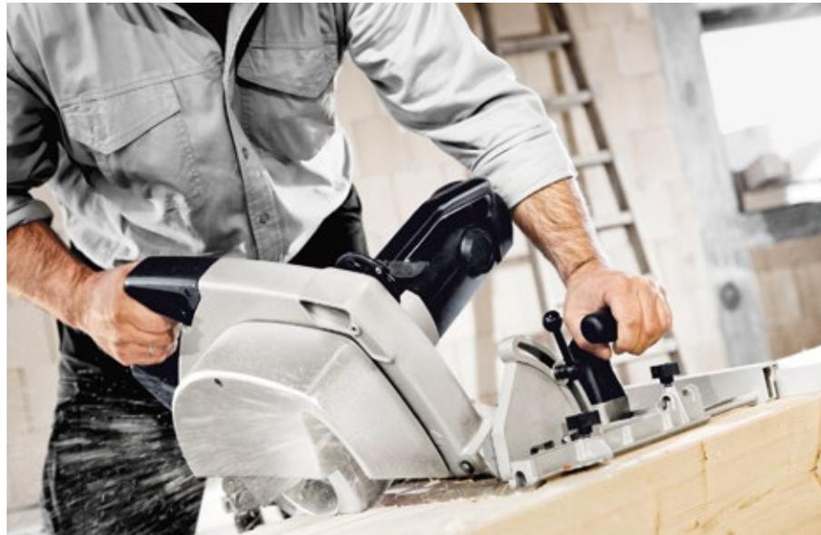
**Sägeblatt raus, Kervenkopf rein:** Die Handkreissäge HK 132 E wird mit Kerveneinrichtung ohne großen Aufwand zur zuverlässigen Kervenerfräse.
