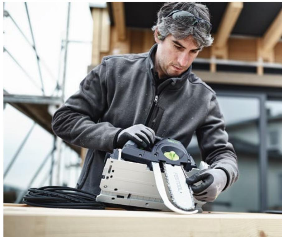
**Vielseitig einsetzbar:** Ob Holz oder Dämmstoffe, die UNIVERS Schwertsäge SSU 220 schneidet alle gängigen Materialien im Holzbau bis zu 200 mm Dicke. Dank Führungsschiene gelingen schnurgerade, ausrissfreie Kapp-, Längs-, Gehrungs- sowie Schifterschnitte problemlos.
