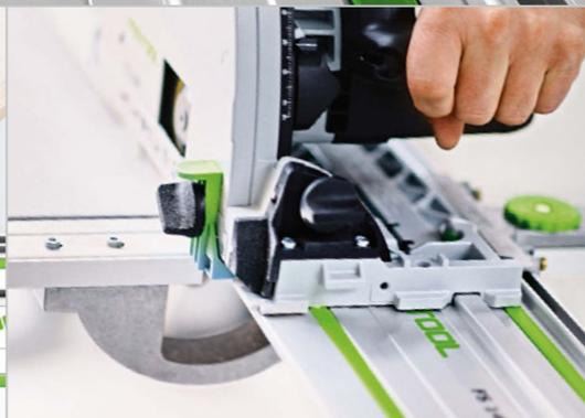
Einfach exakt – die Werkstückbreite ist mit dem Parallelanschlag mit Skala und Anschlagreiter bequem einzustellen.
