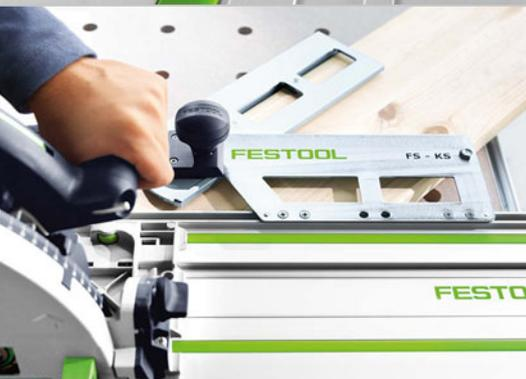
Schnell zum diagonalen Schnitt – mit Führungsschiene und Kombischmiege werden Winkel leicht von Werkstück oder Wand übertragen.
