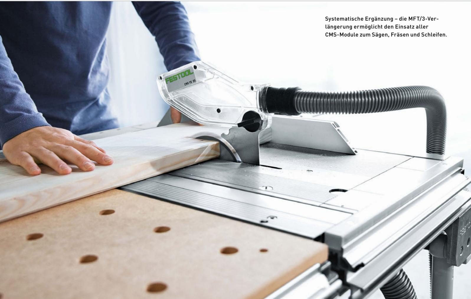
Systematische Ergänzung – die MFT/3-Verlängerung ermöglicht den Einsatz aller CMS-Module zum Sägen, Fräsen und Schleifen.
