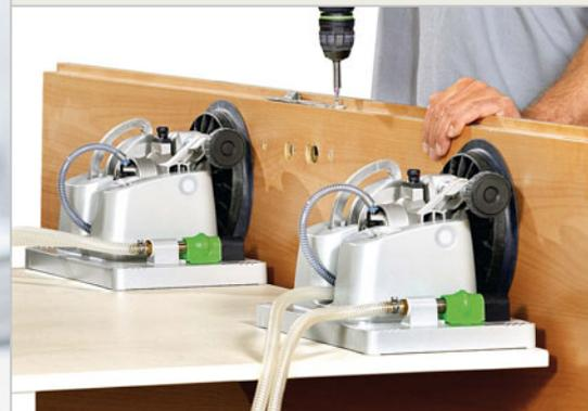
Werkstücke von allen Seiten bearbeiten – sie sind bis zu 360° dreh- und bis zu 90° schwenkbar. So ist ergonomisches Arbeiten ohne Umspannen sichergestellt.
