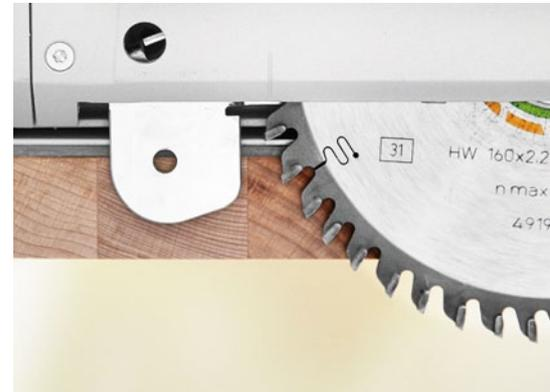
Mehr Sicherheit, mehr Komfort: Der federnd gelagerte Führungskeil tritt vor dem Sägeblatt aus, verhindert das Verkleben und vereinfacht das erneute Ansetzen in bestehende Schnittfugen.
