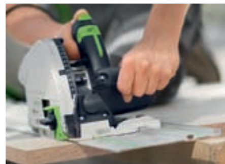
Flossefri snit og hurtige arbejdsgange ved savning: føringsskinne plus dyksav.
