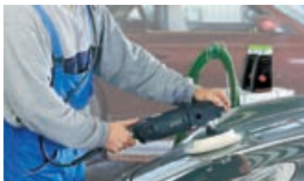
Alle kontakter inden for rækkevidde. Og takket være omdrejningstal fra 0 til 2400/min -1 (med hastighedsindstilling) kan maskinen anvendes til mange forskellige formål.
