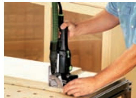
Den flade konstruktion gør DOMINO samlingsfræser yderst fleksibel.
