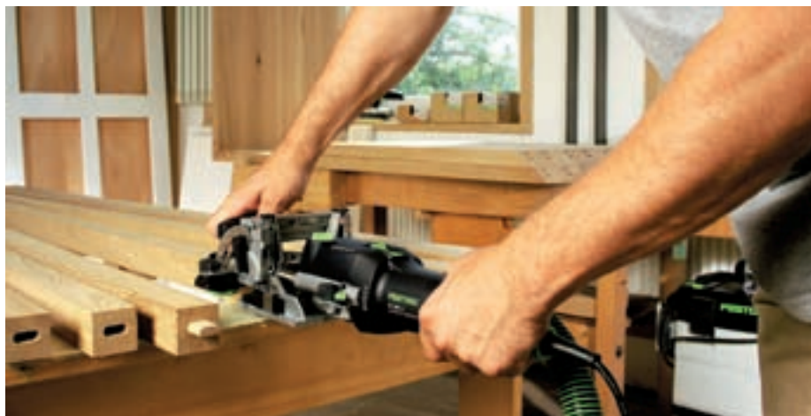
Praktisk tilbehør gør arbejdet lettere. Med listeanslaget justeres små trælister uden problemer, også ideel til fræsning i gering.
