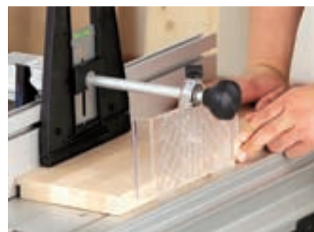
Fræsemodulet CMS og den passende fræser gør det let at fræse mange forskellige former.
