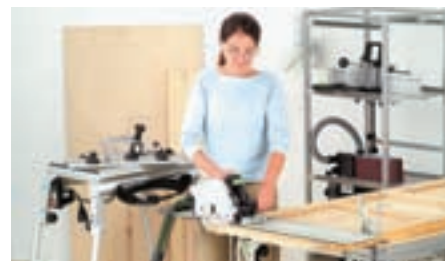
Dyksaven kan både anvendes stationært eller på føringsskinne, er hurtigt afmonteret og kan derfor også vise hele deres styrke på føringsskinne.
