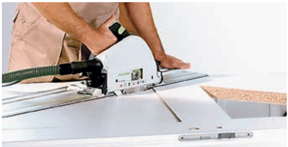
Til enhver udskæring: Med dyksaven fra Festool og føringsskinnen saves der sikkert og nøjagtigt – også når det gælder vanskelige geometriske former.
