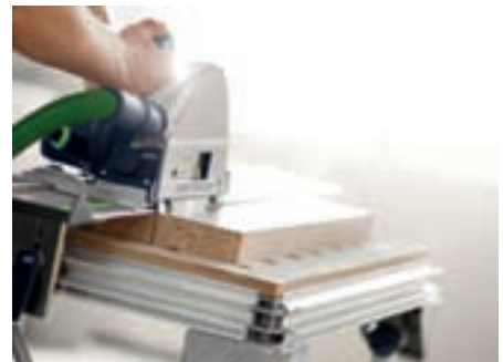
Kombinationen af dyksav og MFT giver sikker fastspænding og optimal føring.
